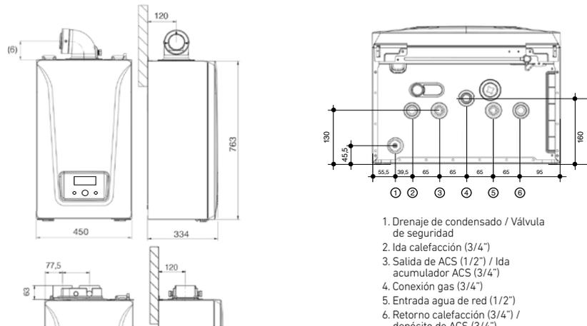
1. Drenaje de condensado / Válvula de seguridad
